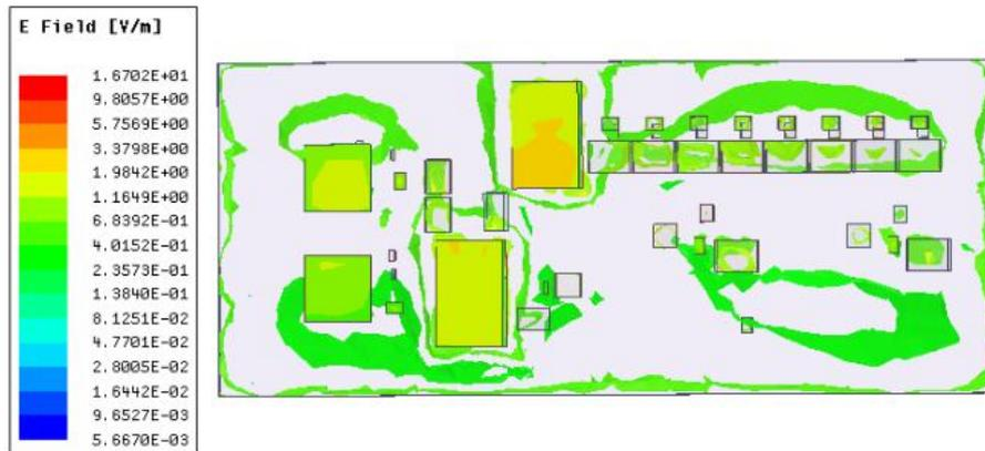
图 B.6 800~2000 MHz CFT 电路板电场分布情况
