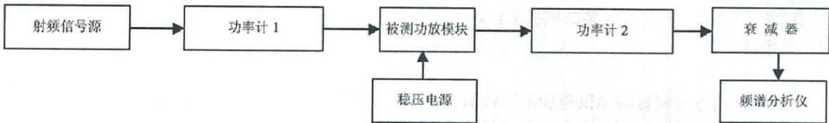
图 1 额定输出功率测试框图
