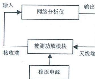
图 10 收通路插损测试框图
