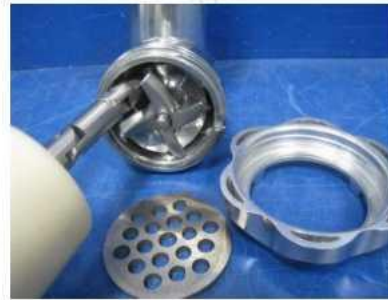
图2 在工作时打开不nj拆卸的端盖并用B型试验探棒触摸刀片
